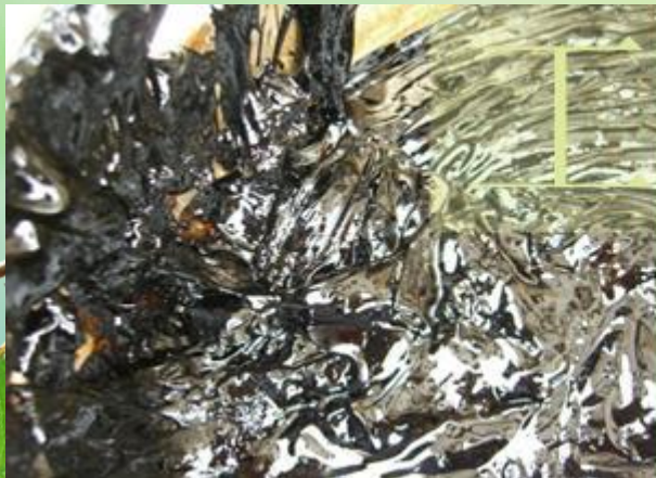
齿轮箱拆开后的，润滑油呈粘稠状，稠度接近4号脂。
